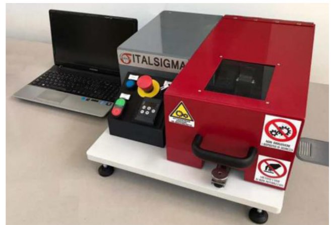
Fig. 3. Mini FP fatigue testing equipment.
