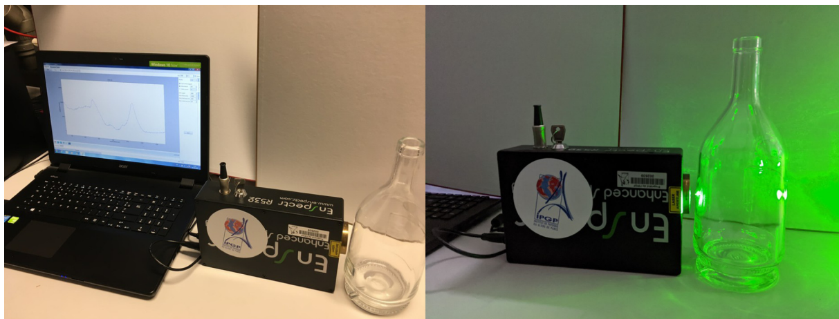
Fig. 2. Photographie d'un système Enspec Raman portable. Le spectre visible sur l'écran de l'ordinateur est acquis en quelques secondes seulement. Photographies Géomatériaux – IPGP.
