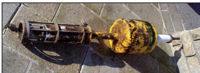
▲ Figure 1 : Sonde SMATCH CTD après 3 mois d'immersion en milieu marin (photo : Elodie Loaec, IFREMER).
