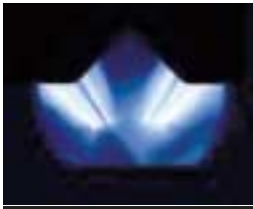
Fig. 1. Photo de l'atmosphère : décharge plasma dans la chambre de pulvérisation d'un magnétron cylindrique rotatif.
