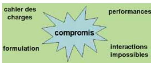
Fig. 3. Compromis de conception entre vitesse de prise et adhérence ; une cinétique élevée nuit en particulier à la diffusion complète des promoteurs jusqu'aux interfaces.
