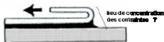
Fig. 5. Localisation des contraintes dans un assemblage pour mesure de pelage.
