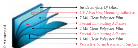
Coupe du film montrant les différentes couches du film et de l'adhésif.
