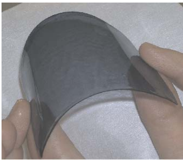
Fig. 3. Matériau électrochrome flexible. (A) Film fortement absorbant. (B) Film à transmission élevée.
